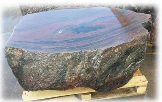
Zuerst wird der Stein bis zur vereinbarten Höhe zugeschnitten, die Tischplatte wird poliert oder gebürstet. Später werden die Öffnungen für Brenner und Anzünder gefertigt. Die vertikale Öffnung ist durch die ganze Steinhöhe, so dass der Gasanschluß ganz leicht und bequem ist.
